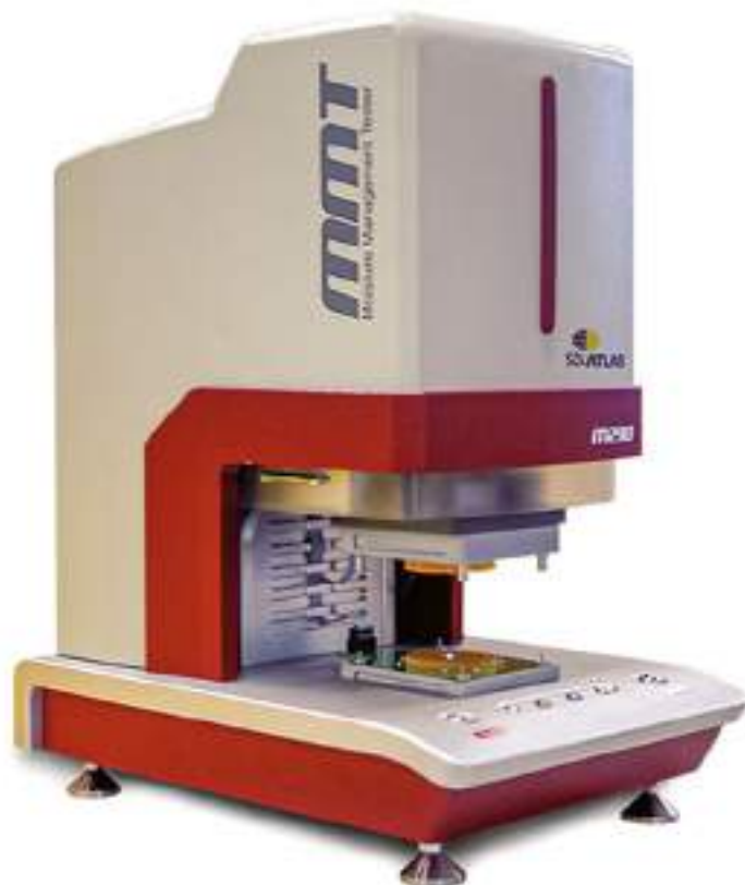
Equipo para la medida de la difusión de la humedad en tejidos (MMT).
