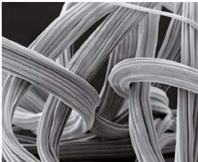
Filamentos de Lycra (microscopía SEM).
