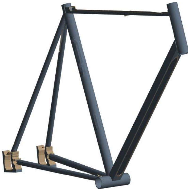
Figura 69. Optimización topológica del modelo de láminas (optimización topométrica)
