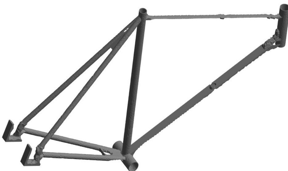
Figura 65. Optimización topológica del modelo sólido
