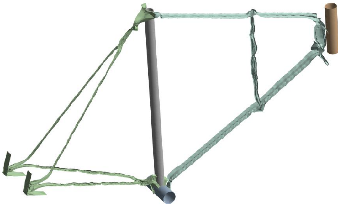
Figura 67. Optimización de forma del modelo sólido
