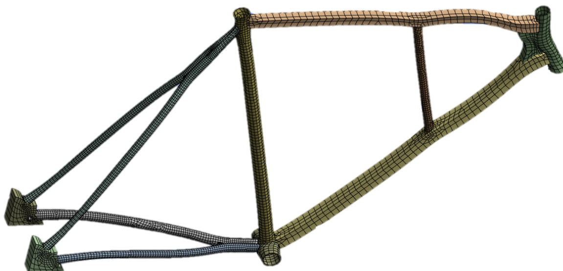
Figura 70. Optimización de forma del modelo de láminas (optimización topográfica)
